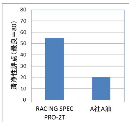
空冷123ccエンジン, 7000r/min, 全負荷, 3h, プラグ座温250°C, 燃料:油混合比35:1
